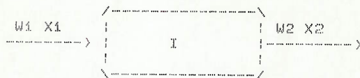
Figura 1: Uma operação unitária I, com um fluxo de alimentação e um de produto.
